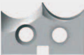
Anschliff für faserverstärkte Kunststoffe (HM)
