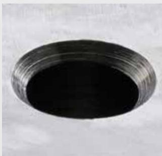
Senkung mit Standardsenker
