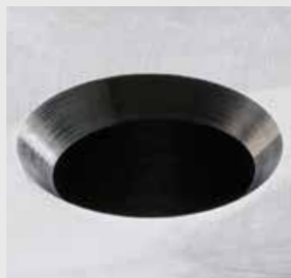
Senkung mit spiralisiertem Kegelsenker
