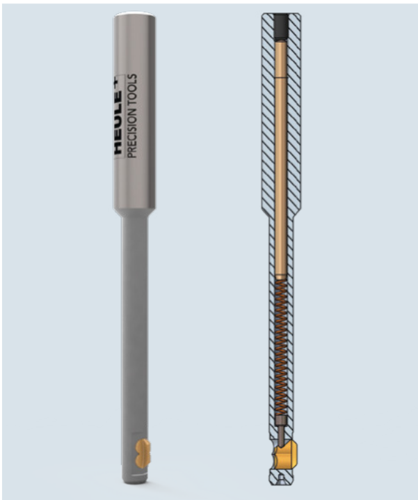
Bild: SNAP5 - Die B-Form des Messers, welche fertigungsbedingt aufwändiger ist, hat sich aufgrund ihrer besserer Führungseigenschaften bei diesem Werkzeugtyp bewährt.
