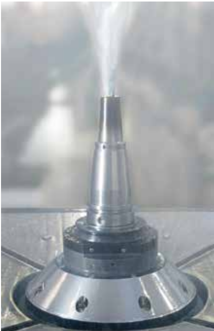
Kühlung bis zur Werkzeugspitze bei 18.000 U/min. Coolant to the top of the cutting tool @ 18.000 rpm.
