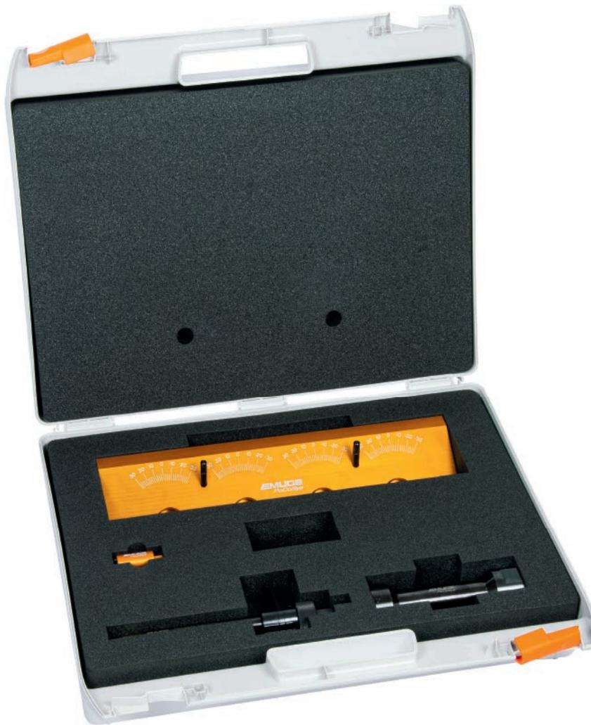
Die Komponenten der **PoCo-Gauge Box** ermöglichen eine manuelle Prüfungsstellungsgewinde direkt am Bauteil an der Fertigungsmaschine. Hierfür werden keine weiteren Geräte oder Messmaschinen benötigt.
