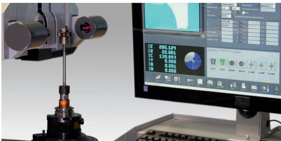
Voreinstellgerät zur vollautomatischen Messung, inklusive automatischer Rotation
