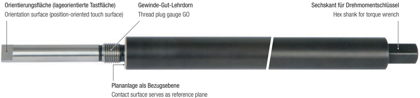
Zur Dokumentation und Qualitätsprüfung stellungsgebundener Gewinde erfolgt die Überprüfung auf 3D-Messmaschinen zusätzlich zur manuellen Methode.
