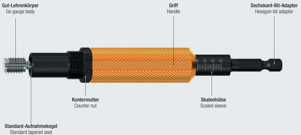
Um die genaue Gewindetiefe zu ermitteln empfehlen wir, den **Gewindetiefen-Lehrdorn „digital IW“** bis zum Gewindegrund einzuschrauben. Die dadurch erreichte Gewindetiefe kann durch das Nullsetzen (RESET) der Anzeige und dem anschließenden Ausdrehen des **Gewindetiefen-Lehrdorns „digital IW“** aus dem Werkstück mit einer Genauigkeit von 0,01 mm abgelesen werden. Somit kann auch an verdeckten Positionen geprüft werden.
